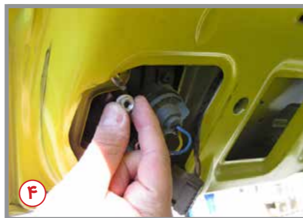
۲ - در این مرحله با استفاده از آچار بکس، شروع به باز کردن مهره های پیچهای چراغ خطر کنید. (مطابق شکل ۳)
